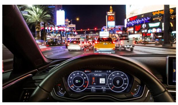
"Time-to-Green": Der Fahrer sieht im Audi virtual cockpit oder Head-up-Display, ob er im Rahmen der erlaubten Geschwindigkeit die nächste grüne Ampel erreicht.
